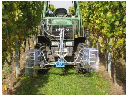
Abb. Mögliches Einsatzgebiet: chemisches Ausbreiten mittels SHARK-Hauben und optoelektronischer Punktspritzung
