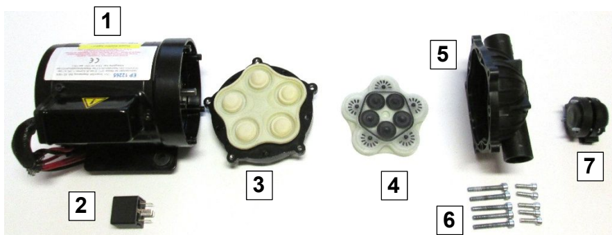
Pumpe zerlegt in einzelne Bauteile
