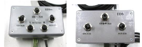
Elektrische Ansteuerungen für Schlepper ohne eigene Schaltersteuerungen
