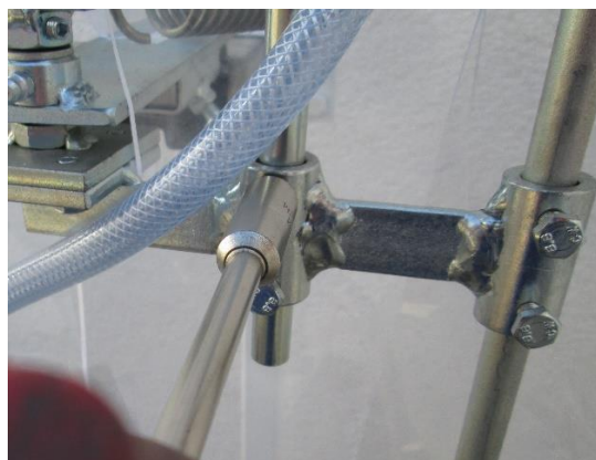
Lösen der Klemmschrauben der Haubenhaltestange
