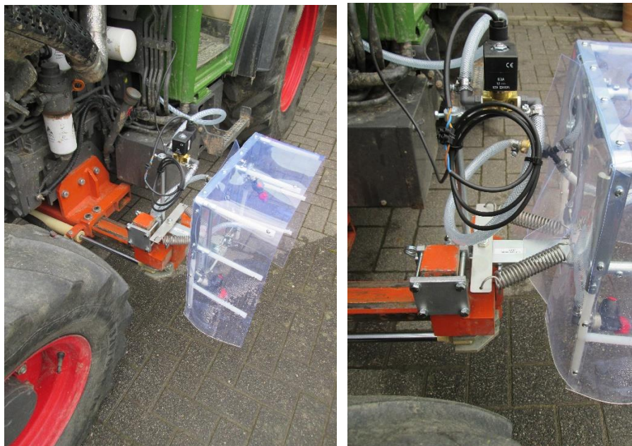
Montage linke Seite (Abbildung mit Sonderausstattung Magnetventil)
