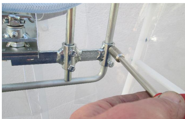
Lösen der Klemmschrauben des Düsenbügels
