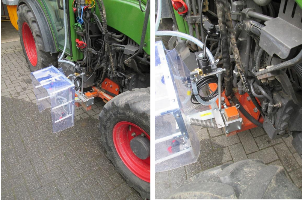
Montage rechte Seite (Abbildung mit Sonderausstattung Magnetventil)
