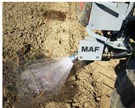
Gießstrahl nach Sensorauslösung durch Rankdraht ( Parameter: Spritzdruck und Zeitimpuls)
