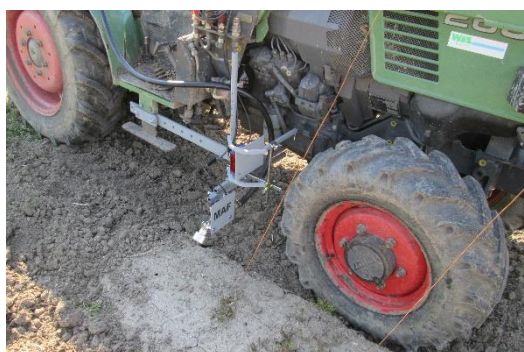
Zwischenachs-Anbau rechts an Fendt 260V (Anbauteile teilweise Sonderanfertigung)
