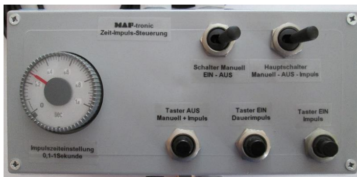
Steuerbox mit Zeiteinstellung und Funktionsschalter
