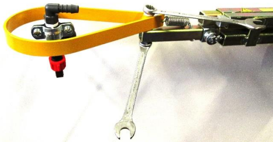
1. Lösen der Gelenkschraube M8 mit SW13
