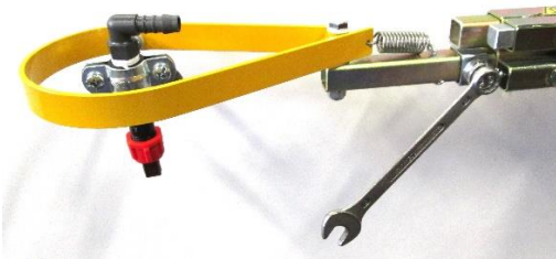
1. Lösen der Klemmschraube M8 SW13 des Vorschubklemmstückes
