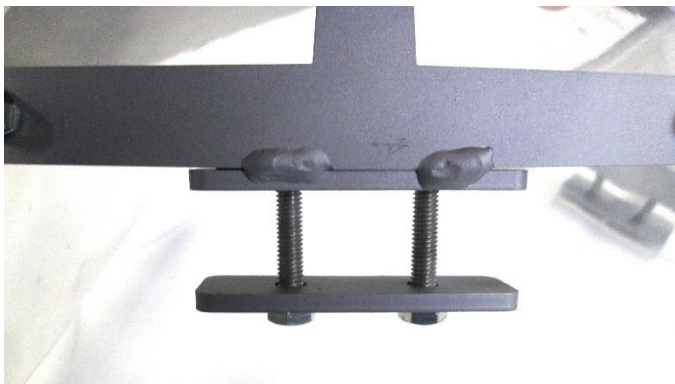
Lösen der beiden Klemmschrauben M6x30 SW 10 bis der Schraubenschaft bündig mit der Lasche ist.
