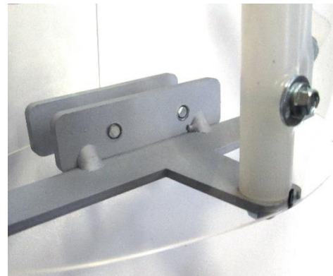
Lösen der beiden Klemmschrauben M6x30 SW 10 bis der Schraubenschaft bündig mit der Lasche ist.
