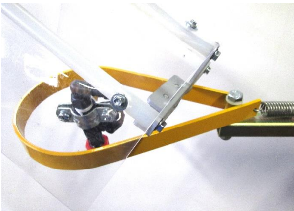
Ansicht in Fahrtrichtung rechts. Wichtig: Erstmontage ohne Schlauch, Abdeckhaube in Abweiserbügel einklappen und bis zum Anschlag der beiden Klemmschrauben einschieben.
