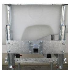
Montagebrücke für MAF uni Bandspritzgestänge
