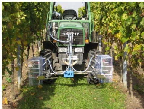
Abb. Mögliches Einsatzgebiet: chemisches Ausbreiten mittels SHARK-Hauben und optoelektronischer Punktspritzung
