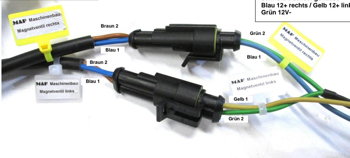
Anschluss Magnetventile bei uni 1 + 2 EDS und uni 1 + 2 EDSm / bei EDS01t1mPok
