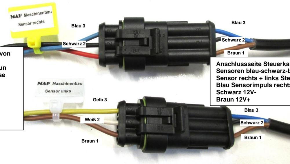
Anschluss Sensoren bei EDS01t1mPo und EDS01t1mPok
