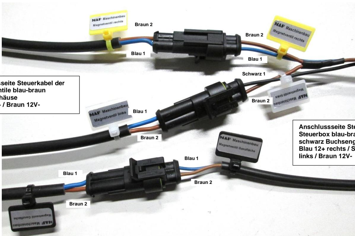
Anschluss Magnetventile bei EDS und EDSm mit zusätzlichen Magnetventil Ganzfläche
