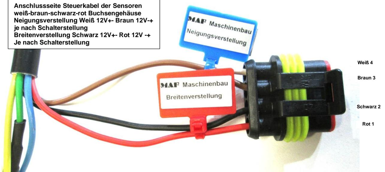
Anschlussmöglichkeit Gestängeantriebe (Breite und Neigung) bei EDS01t1mPo und EDS01t1mPok
