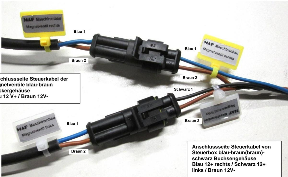
Anschluss Magnetventile bei EDS und EDSm
