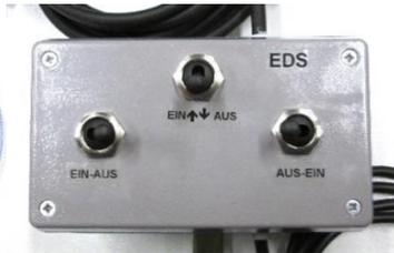
Nachrüstatz elektrische Düsenschialtung mit Magnetventilen für links und rechts (für Magnetventile sind Ersatzteile lieferbar), Halter, Schlauch 10mm 2x1,2m, Schlauchschellen, Anschlußverschraubung 10mm, Maximaldruck 7bar, Steuerbox und Halter, für MAF uni 0 + uni 1 + uni 2
