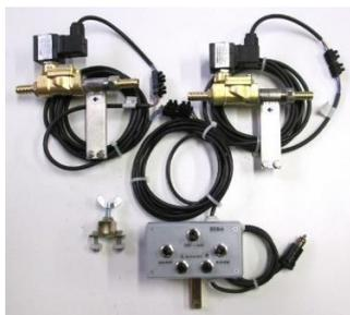
Nachrüstatz elektrische Düsenschialtung mit Magnetventilen für links und rechts einzeln (für Magnetventile sind Ersatzteile lieferbar), Halter, Schlauchanschlüsse 12mm, Anschlußverschraubung 12mm, Maximaldruck 16bar, Steuerbox und Halter, Durchfluß je Ventil 70 Ltr/min
