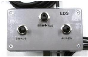
Nachrüstset elektrische Düsenschialtung mit Magnetventilen für links und rechts einzeln (für Magnetventile sind Ersatzteile lieferbar), Halter, Schlauchanschlüsse 10mm, Maximaldruck 7bar, Steuerbox und Halter, für MAF uni 3
