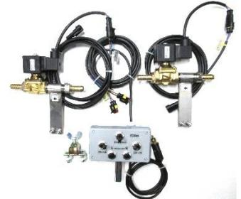
Nachrüstatz elektrische Düsenschialtung mit Magnetventilen für links und rechts einzeln (für Magnetventile sind Ersatzteile lieferbar), Halter, Schlauchanschlüsse 12mm, Anschlußverschraubung 12mm, Maximaldruck 20bar, Steuerbox und Halter, Durchfluß je Ventil 45 Ltr/min
