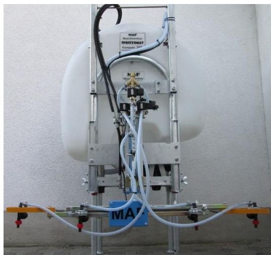
Ausstattung mit Bandspritzgestänge MAF uni 1 ED5m und hydraulischer Höhenverstellung und Ganzflächenabspritzung
