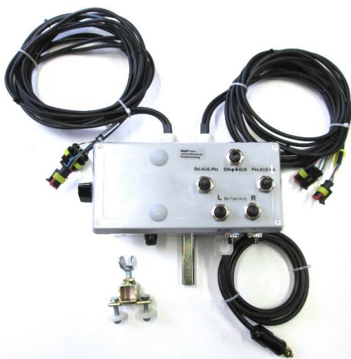
Steuerbox mit Zeiteinstellung und Funktionsschalter für linke und rechte Seite
