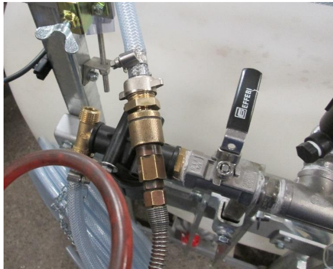
Mundstück im angeschraubten Zustand mit Druckluftkupplung (maximaler Luftdruck 4bar ideal 1-1,5bar)
