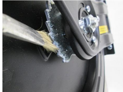
Rastscheibe und Sperrklinke schmieren (Weißöl oder säurefreies Fett)
