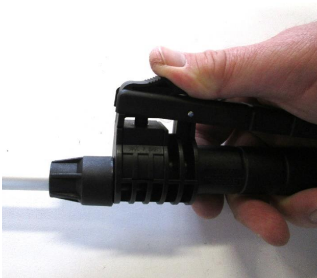
Griffstück in Stellung offen, Schalthebel gedrückt,
