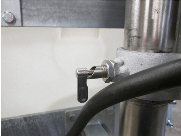
Sicherungsstift offen Trommel ist schwenkbar
