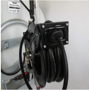
Schlauchanschlag an Führungsrollen
