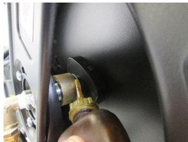
Schlauchanschluss mit Wellendichtung ölen (Weißöl)
