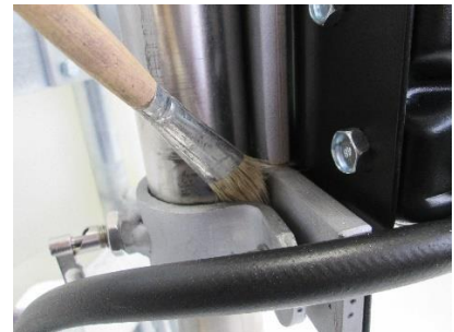
Drehgelenk schmieren (Säurefreies Fett)
