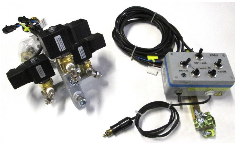
13. Elektrische Düsenschialtung mit 3 Magnetventilen (Ganzfläche)
