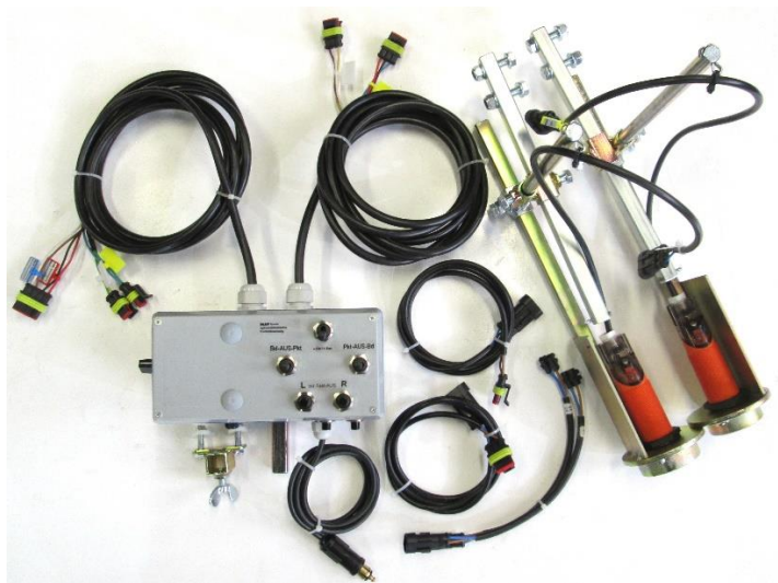
14. Elektrische Düsenschialtung mit optoelektronischer Punktsteuerung
