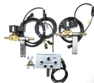
Nachrüstsatz elektrische Düsenabschaltung mit Magnetventilen für links und rechts einzeln (für Magnetventile sind Ersatzteile lieferbar), Halter, Schlauchanschlüsse 12mm, Anschlußverschraubung 12mm, Maximaldruck 16bar, Steuerbox und Halter, Durchfluß je Ventil 70 Ltr/min
