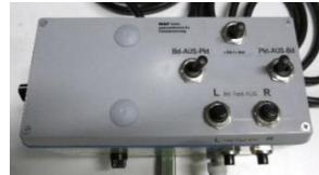
Nachrüstsatz elektrische Düsenabschaltung mit Momentabschaltung und optoelektronischer Punktspritzung, Optosensoren für links und rechts mit Halter, Steuerbox mit Halter, Magnetventile mit Halter, für MAF uni 0 + uni 1 + uni 2
