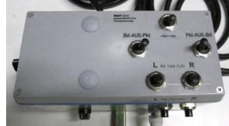
Nachrüstsatz elektrische Düsenabschaltung mit Momentabschaltung und optoelektronischer Punktspritzung, Optosensoren für links und rechts mit Halter, Steuerbox mit Halter, für MAF uni 0 + uni 1 + uni 2
