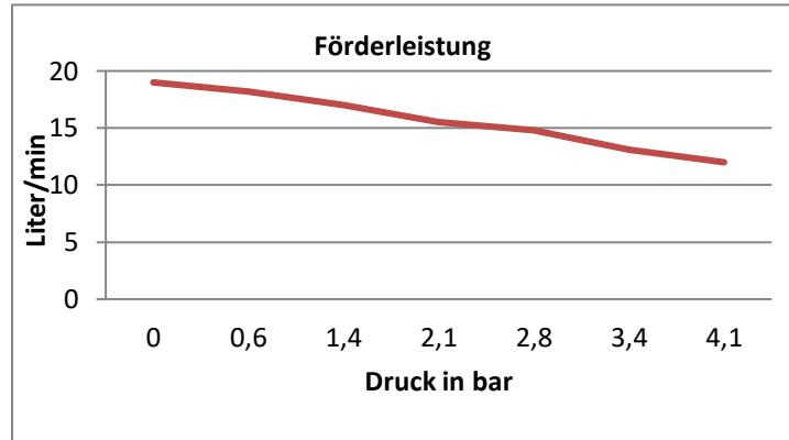
**Spannung/Stromstärke:** 12V = / 17A dauerlaufgeeignet **Absicherung direkt an Pumpe** 20-25 A**Druck max.:** 4,1 bar > Selbstabschaltung**Ansaughöhe max.:** 2,4 m**Durchflussmenge max.:** 18,9 l/min**Länge:** 222mm **Breite:** 132mm **Höhe:** 121mm**Gewicht:** 2,67 kg**Elektrischer Anschluss:** rot 12V+
