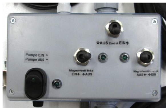
Elektrische Ansteuerung Typ 2 b mit Kontroll-LED für Schaltzustand
