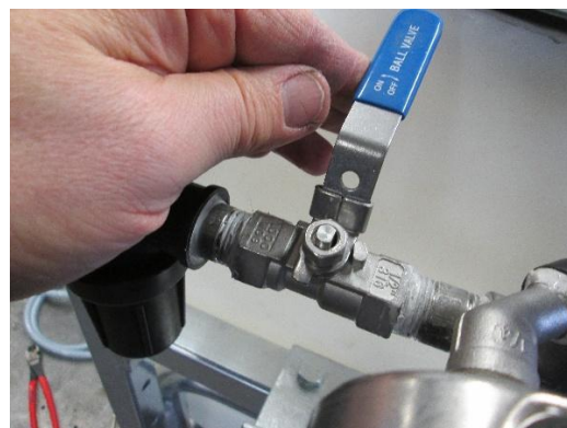
Kugelhahn in Stellung offen entriegelt
