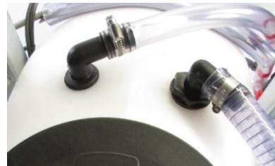
Oberer Stutzen Füllstandsanzeige / Stutzen Rücklauf Rührwerk
