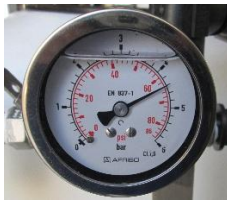
Druckanzeige 4,4 bar Abschaltdruck der Pumpe
