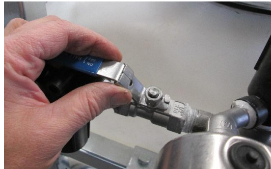
Kugelhahn in Stellung offen entriegelt
